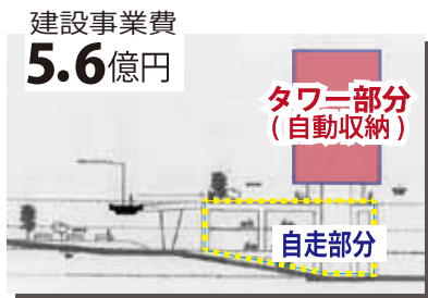
▲取手駅西口・駅ビルボックスビルと「医療ビル」の間に建設予定
